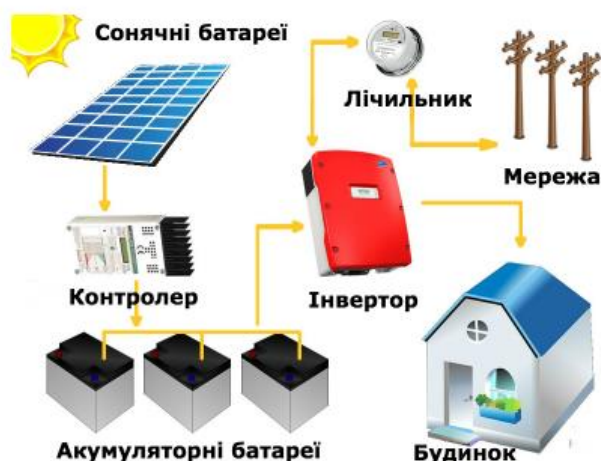
Рисунок 2.2 – Схема автономної електростанції
