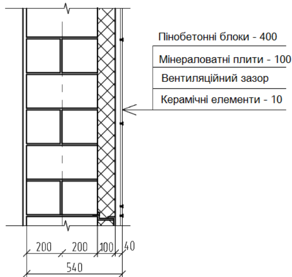
Рисунок 1.1 – Розрахункова схема стіни
