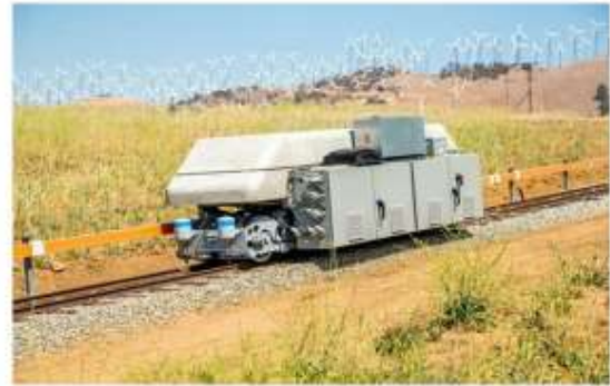
Гравітаційний накопичувач електроенергії вагонеткового виконання
