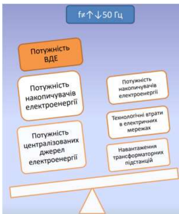
Рисунок 1.9 Небаланс в ОЕС внаслідок безконтрольного інтегрування потужностей ВДЕ
