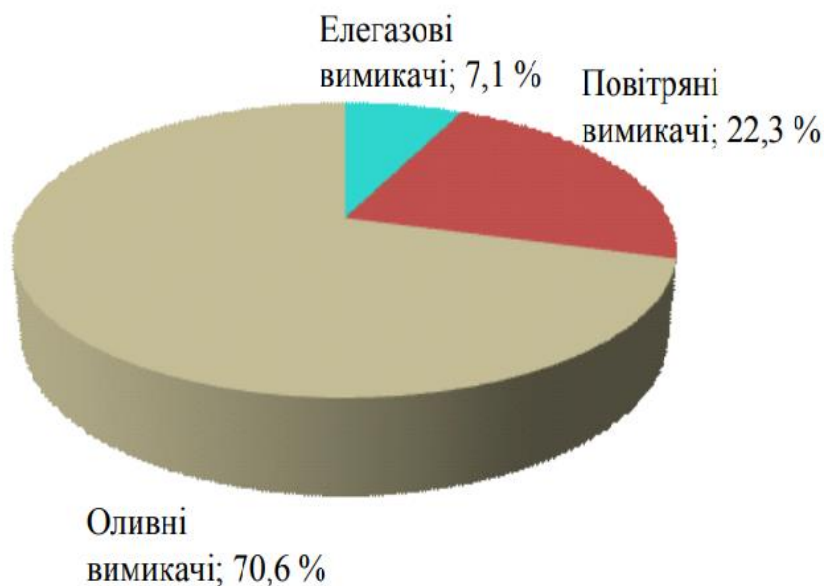
Рисунок 2.9 – Діаграма відмов високовольтних вимикачів
