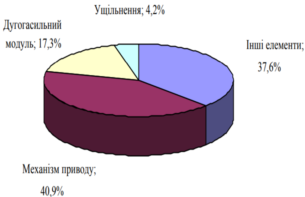
Рисунок 2.7 – Діаграма відмов елегазових вимикачів
