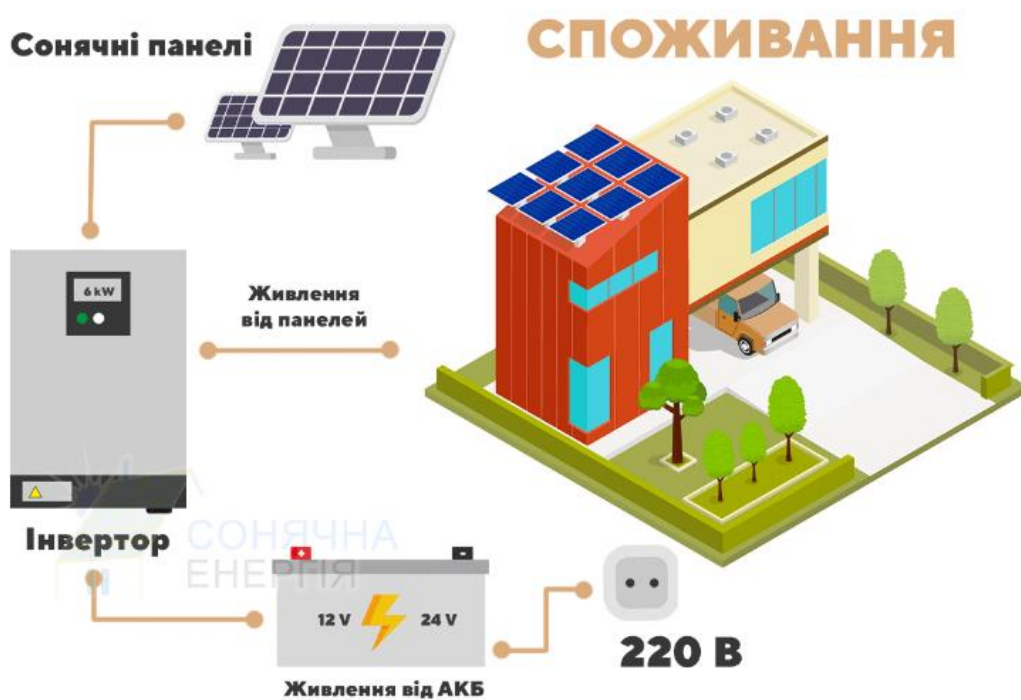
Рисунок 2.2 – Схематичне зображення автономної сонячної електростанції та перелік її обладнання
