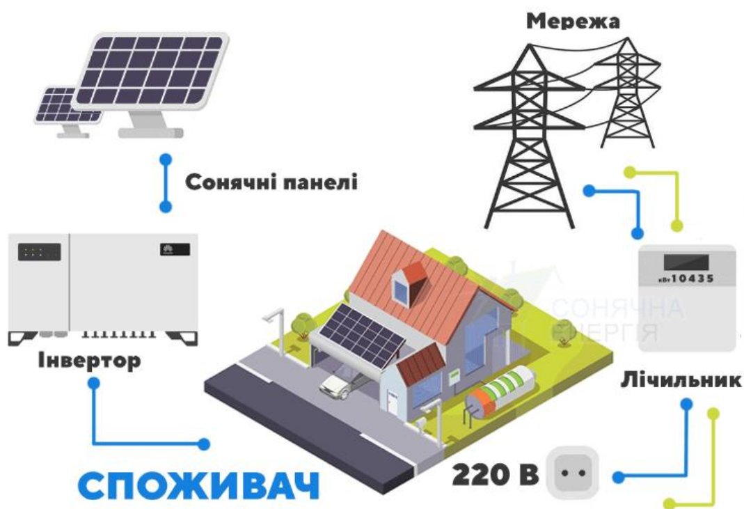
Рисунок 2.1 – Схема мережевої сонячної електростанції та її обладнання
