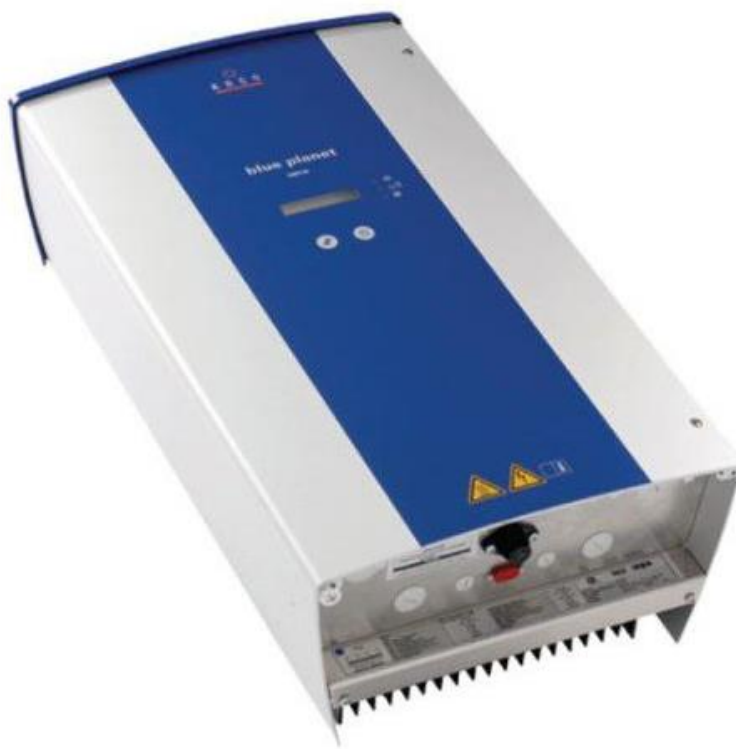
Рисунок 2.4 – Зображення одного з різновидів автономних інверторів
