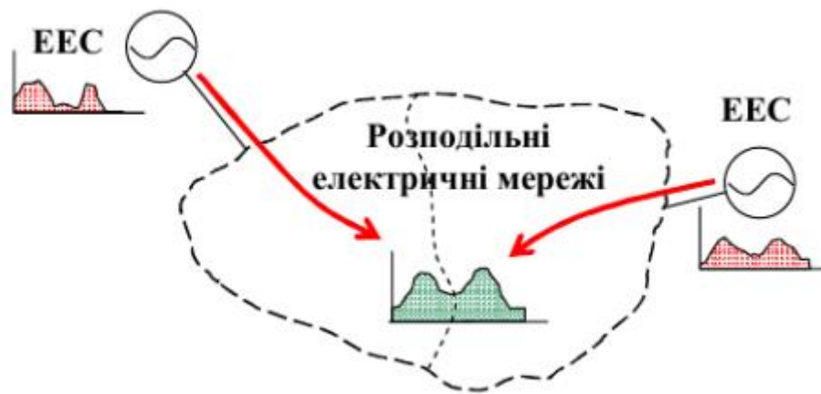
Рисунок 1.3 – Розподільні електричні мережі із централізованим живленням
