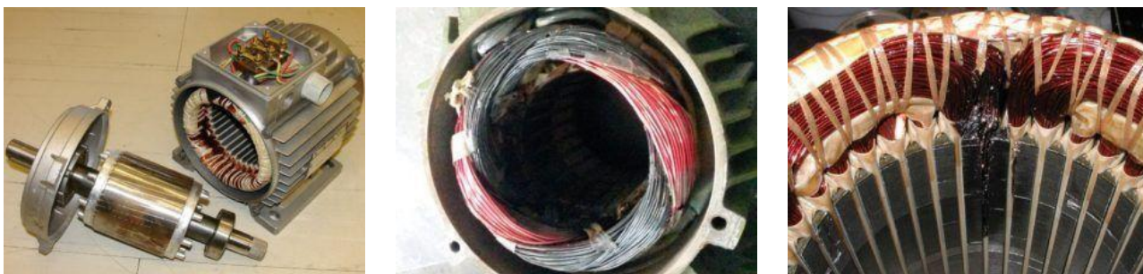
Пошкодження обмотки статора
