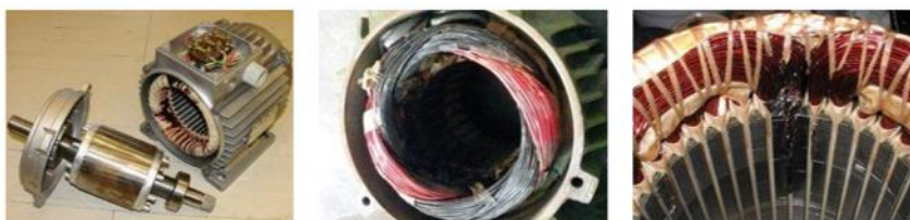
Пошкодження обмотки статора
