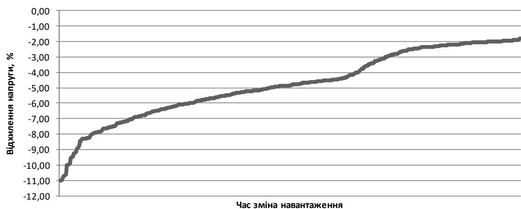
Рисунок 1.13 – Відхилення напруги на затискачах ТП-457 протягом року
