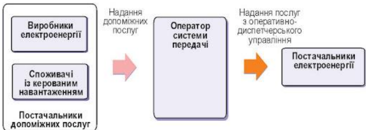
Рисунок 2.3 – Схема роботи ринку допоміжних послуг
