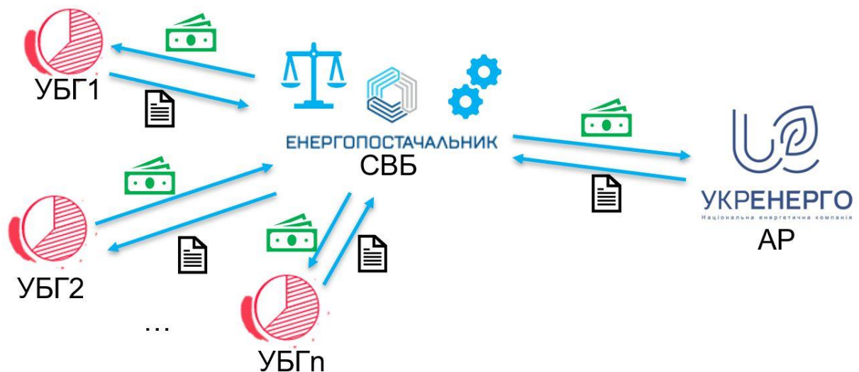
Рисунок 2.2 – Схема здійснення розрахунків за небаланси між учасниками балансуючих груп (УБГ), балансуючою групою, що виступає стороною, відповідальною за баланс (СВБ) та адміністратором розрахунків НЕК «Укренерго» (АР)
