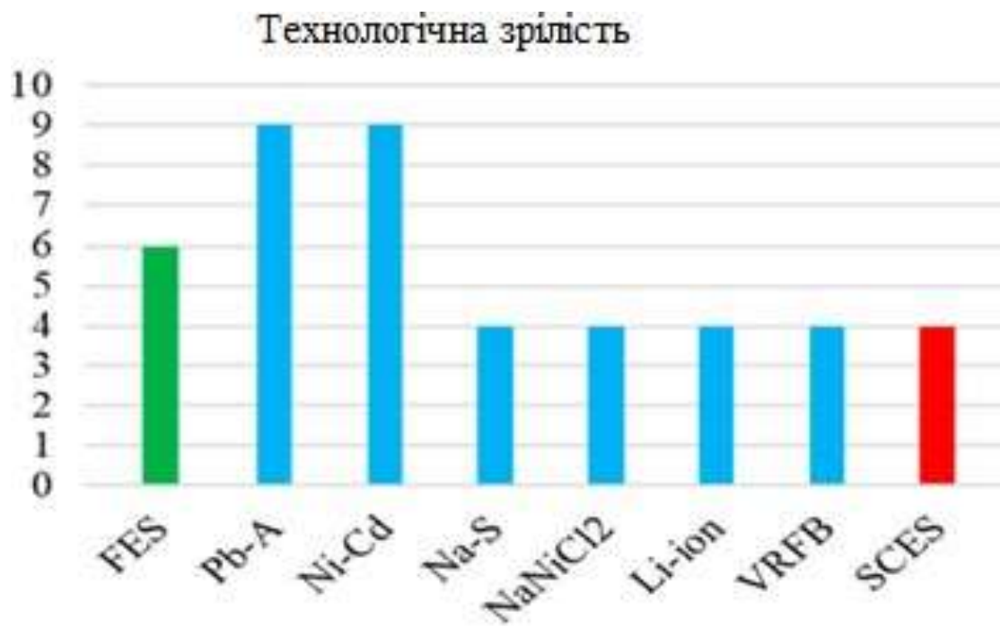
Рисунок 1.9 - Порівняння технологічної зрілості окремих технічних засобів накопичення енергії
