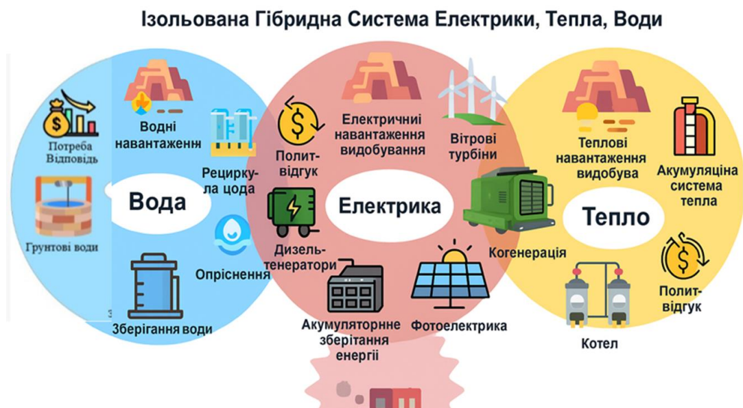
Рисунок 1. Інтегрована ізольована гібридна система виробництва електроенергії, тепла та води.
