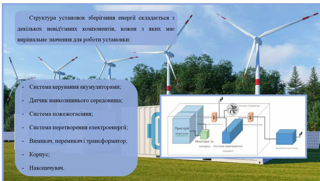
Рисунок В.6 – Структура установок зберігання електроенергії
