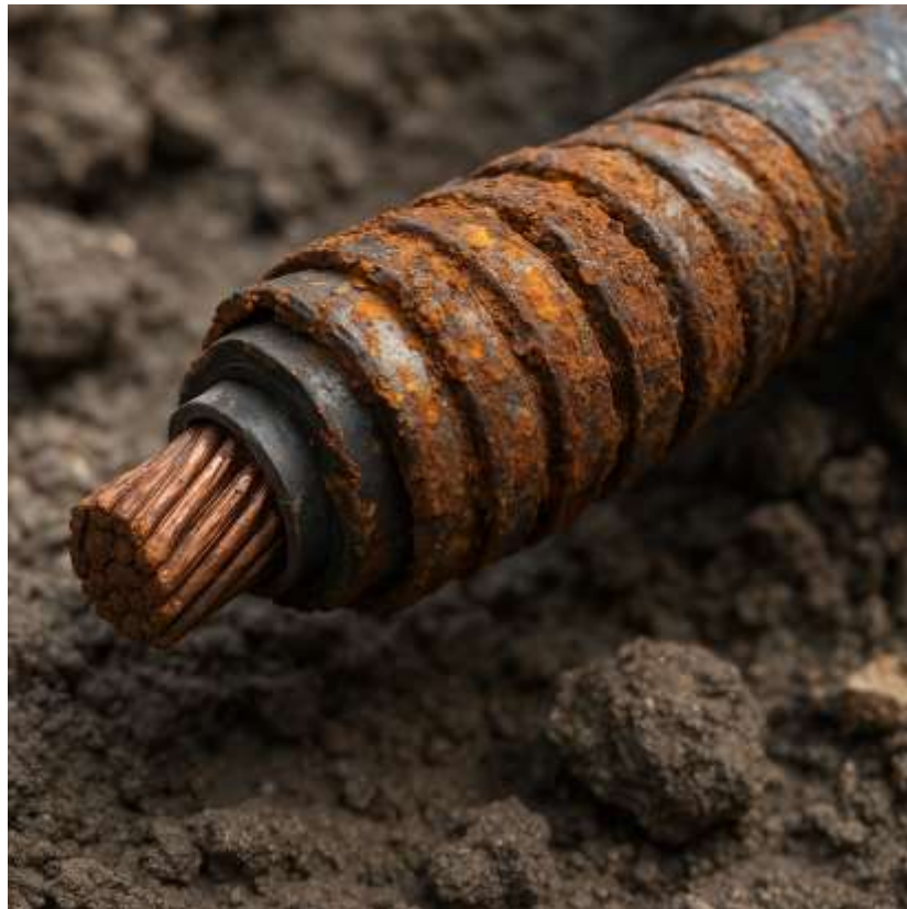
Рисунок 1.6 - Корозія броні та металевих оболонок КЛ
