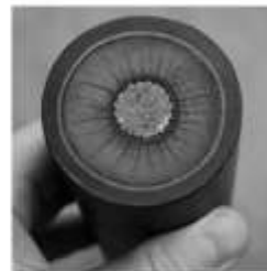
Рисунок 2 - Теплове старіння ізоляції
