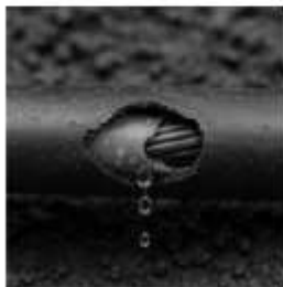
Рисунок 3 - Порушення герметичності оболонки КЛ
