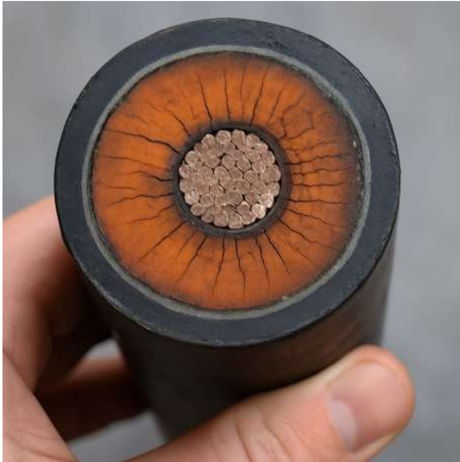
Рисунок 1.2 - Теплове старіння ізоляції
