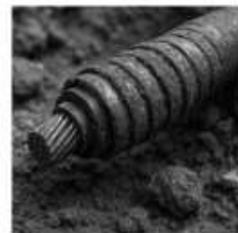
Рисунок 6 - Корозія броні та металевих оболонок КЛ
