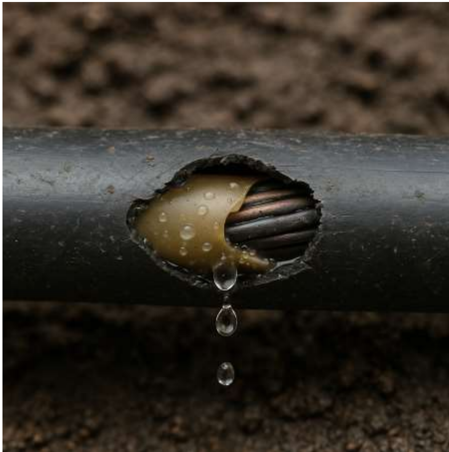
Рисунок 1.3 - Порушення герметичності оболонки КЛ
