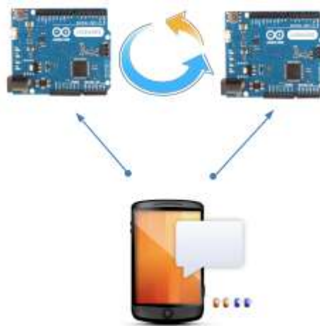
Рис. 1.2 – Принцип роботи вбудованої системи без центрального контролера
