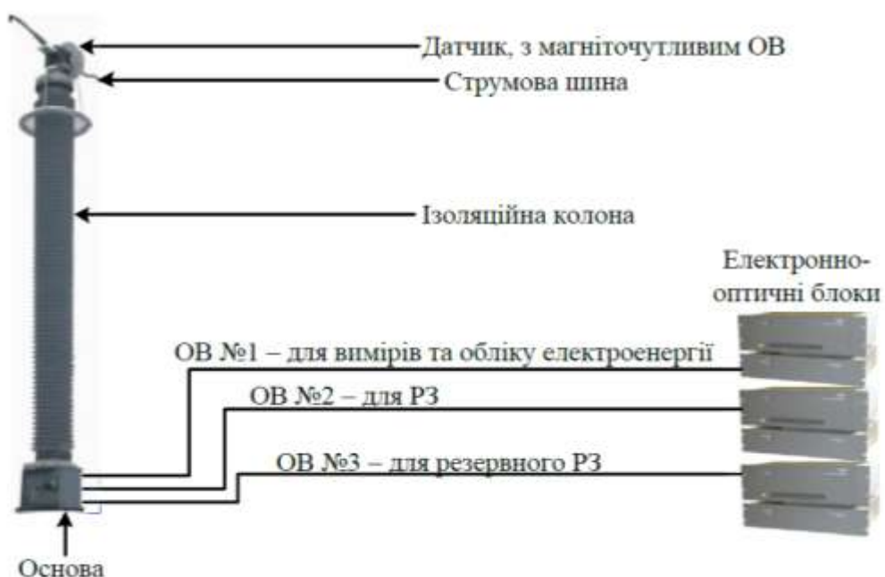
Рисунок 3.3 – Конструкція ізоляційної колони з пристроєм ВОТ.
