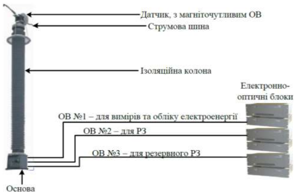
Конструкція ізоляційної колони з пристроєм ВОТ
