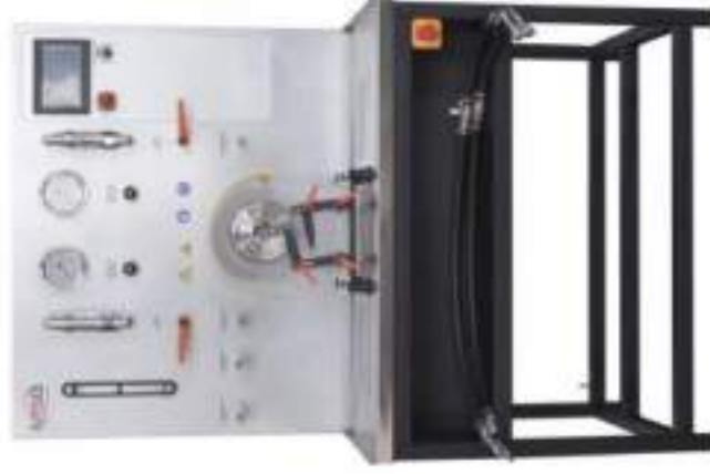
Стенд для діагностики насосів гідропідсилювача керма MS504
