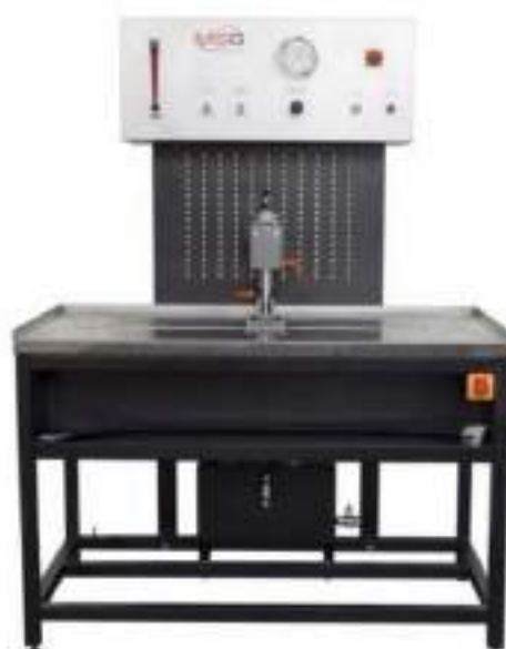
Рисунок 3.5 – Стенд для діагностики рульових рейок з гідропідсилювачем MS502M
