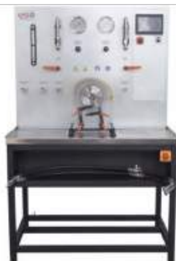
Рисунок 3.4 – Стенд для діагностики насосів гідропідсилювача керма MS504
