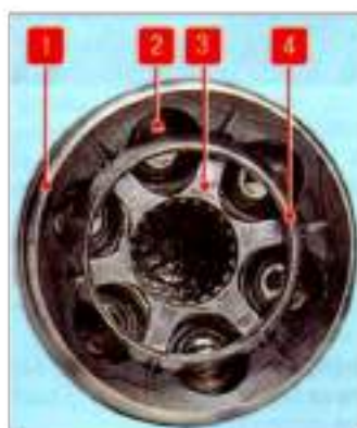
1 – корпус; 2 – кулька; 3 – обойма; 4 – сепаратор
