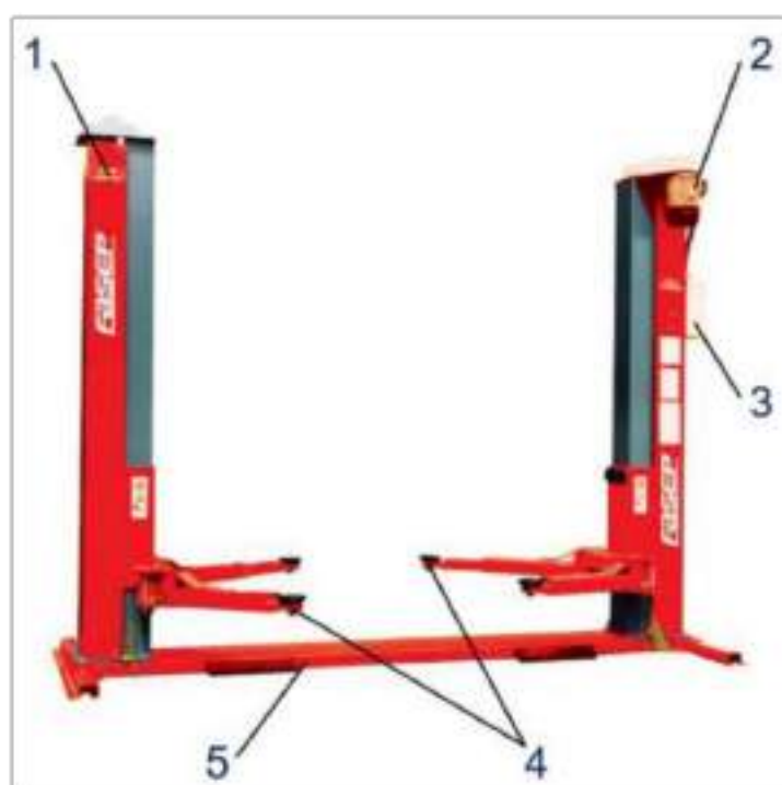
1 – стовп з гвинтовим механізмом; 2 – електродвигун; 3 – пульт керування; 4 – підхвати; 5 – синхронізація між стовпами
