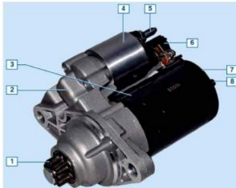
1 - шестерня приводу; 2 - передня кришка; 3 - корпус стартера; 4 - тягове реле; 5 - контактний болт; 6 - роз'єм тягового реле; 7 - задня кришка; 8 - стяжний болт Рисунок 1.5 – Загальний вигляд стартера автомобіля Volkswagen Polo
