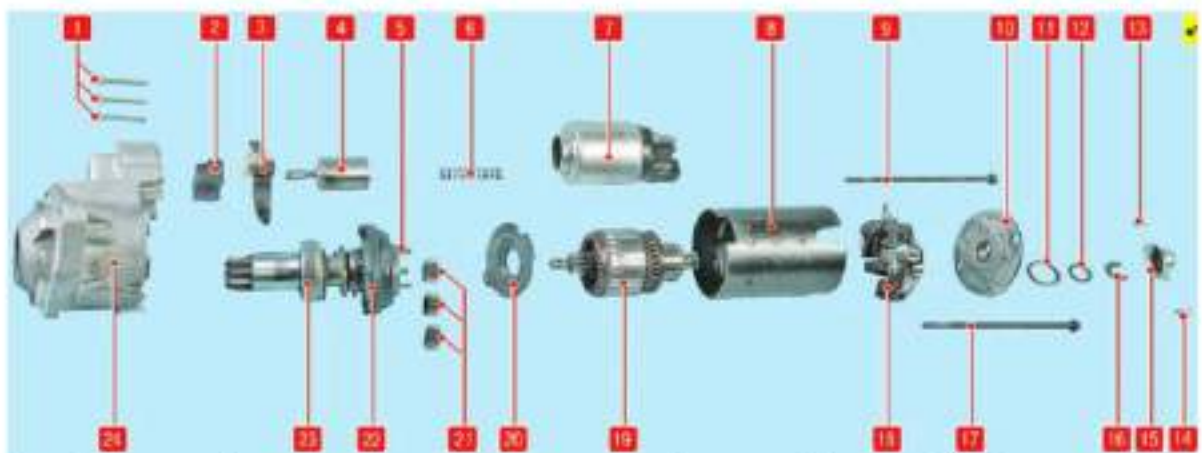
1 - болти кріплення тягового реле до передньої кришки; 2 - гумовий ущільнювач; 3 - важіль приводу; 4 - якір тягового реле; 5 - вал приводу; 6 - поворотна пружина; 7 - тягове реле; 8 - корпус статора; 9, 17 - стяжні болти; 10 - задня кришка; 11 - кільце ущільнювача; 12 - упорне кільце ротора; 13, 14 - гвинти кріплення кришки підшипника; 15 - кришка підшипника; 16 - стопорне кільце ротора; 18 - щітковий вузол; 19 - ротор; 20 - масловідбивач; 21 - сателіти; 22 - коронна шестерня; 23 - муфта приводу; 24 - передня кришка
