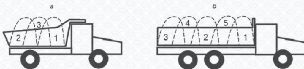
Рисунок 2.1 - Завантаження кузова самоскида асфальтобетонною сумішшю: а) завантаження кузова у три прийоми; б) завантаження кузова за п'ять прийомів
