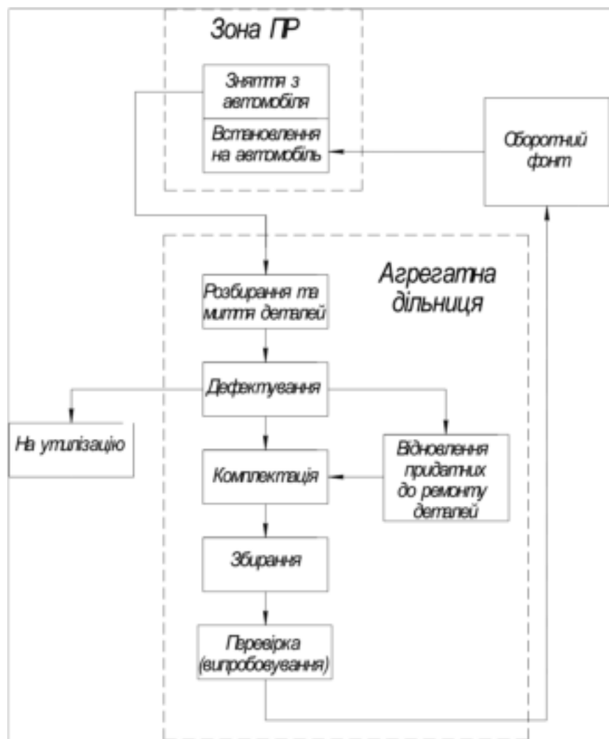
Рисунок 3.1 – Загальна схема технологічного процесу ремонту водяного насосу
