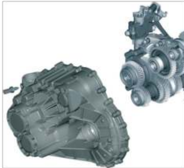
Рисунок 1.5 - Розібраний вигляд КПП – ліва сторона
