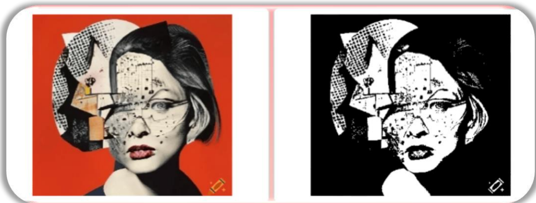
Рисунок 3.9 – Приклад роботи методу Otsu's Thresholding
