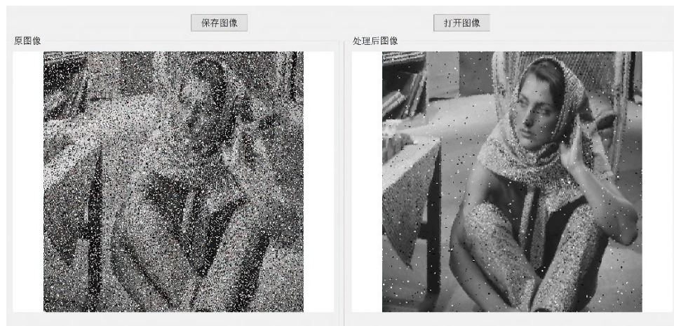
Рисунок 2.6 – Медіанна фільтрація імпульсного шуму
