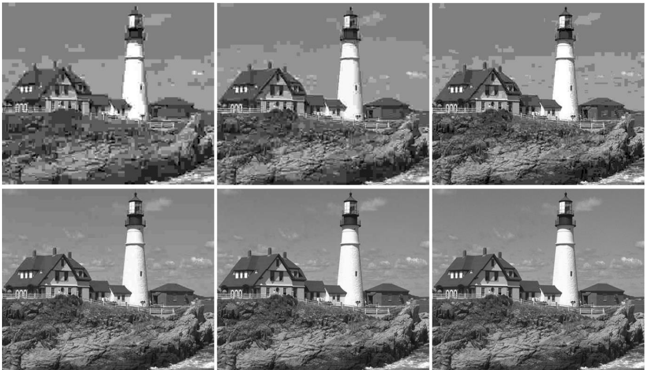
Рисунок 3.4 – Зображення №21 з бази KODAK після компресії для різних рівнів якості VIF (рядково зліва направо: 0.11, 0.21, 0.31, 0.46, 0.68 та 0.99)
