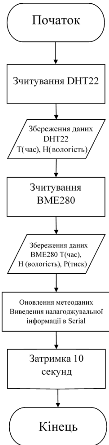
Рисунок Б.4 – Етапи процесу зчитування даних з датчиків
