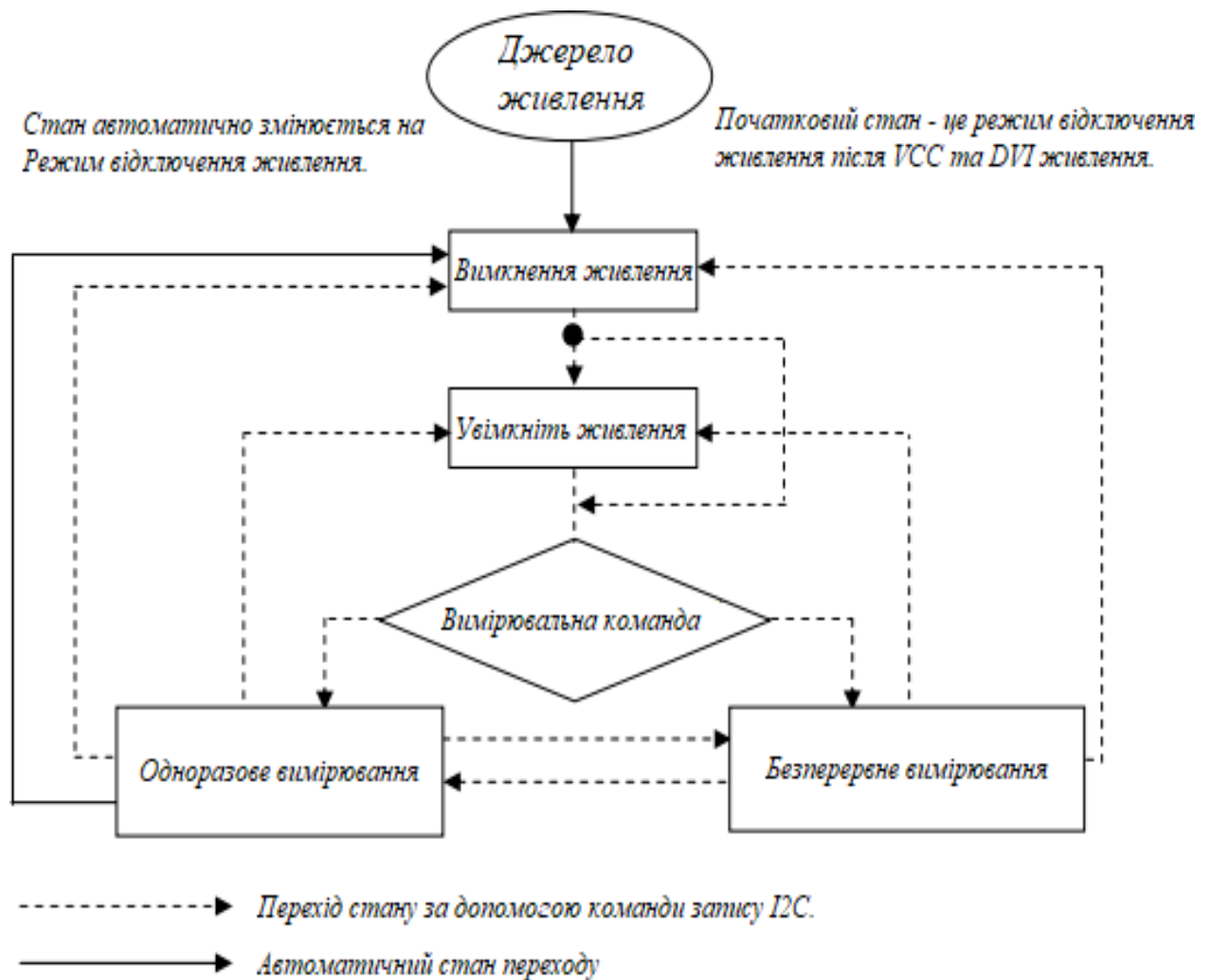
Рисунок 3.5 – Алгоритм роботи BH1750
