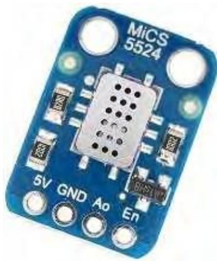
Рисунок 3.6 – Модуль датчика якості повітря MICS-5524 TVOC
