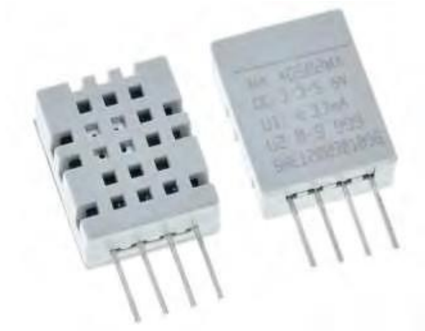
Рисунок 3.7 – Датчик якості повітря AGS02MA
