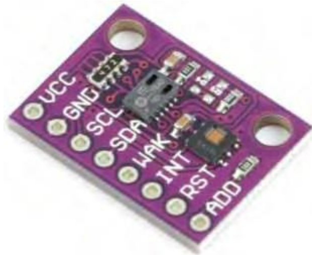
Рисунок 3.5 – Комбінований модуль датчиків якості повітря CCS811 і HDC1080
