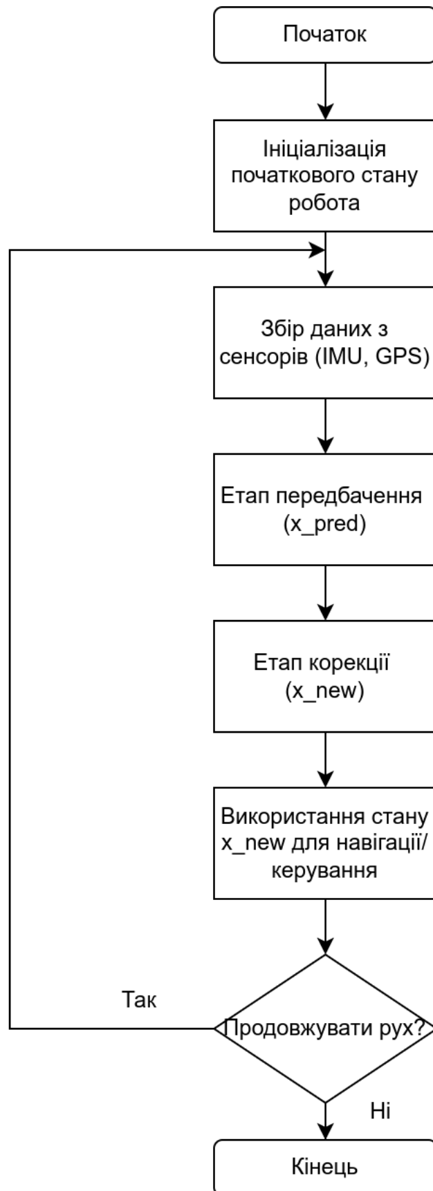
Рисунок Б.1 – Схема програми розширеного фільтру Калмана для системи навігації наземного робота
