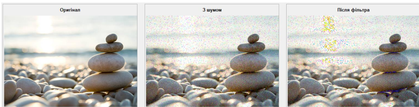
Рисунок 3.8 – Результат вейвлет-фільтрації з імпульсним шумом.
