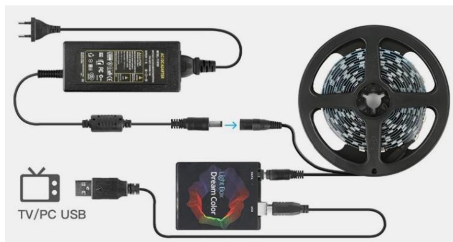
Рисунок 2.3 – Приклад організації підсвітки на базі спеціального ПЗ
