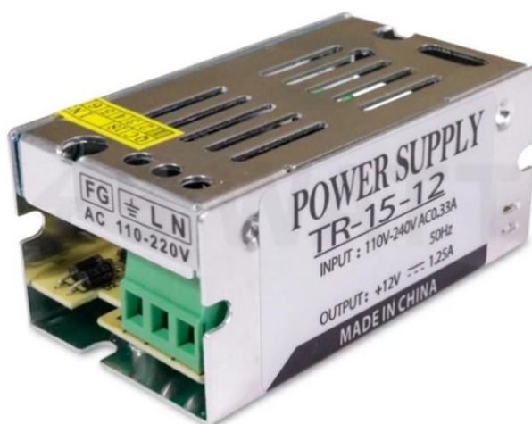
Рисунок 2.11 – Блок живлення 12В/15W
