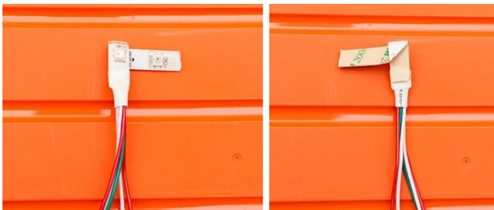
Рисунок 2.17 – Організація кута 90^0 на світлодіодній стрічці
