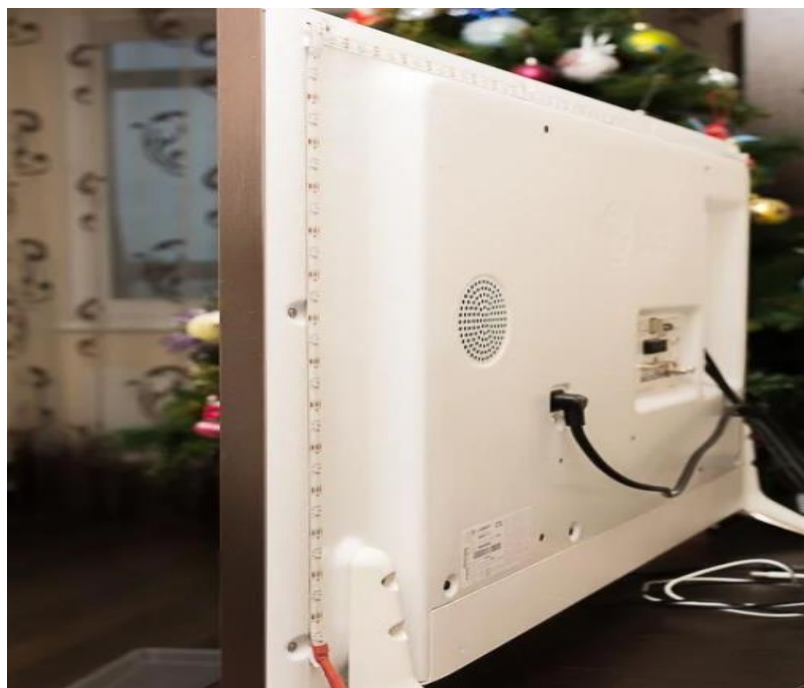
Рисунок 2.18 – Зовнішній вигляд встановленого на монітор пристрою інтелектуальної підсвітки
