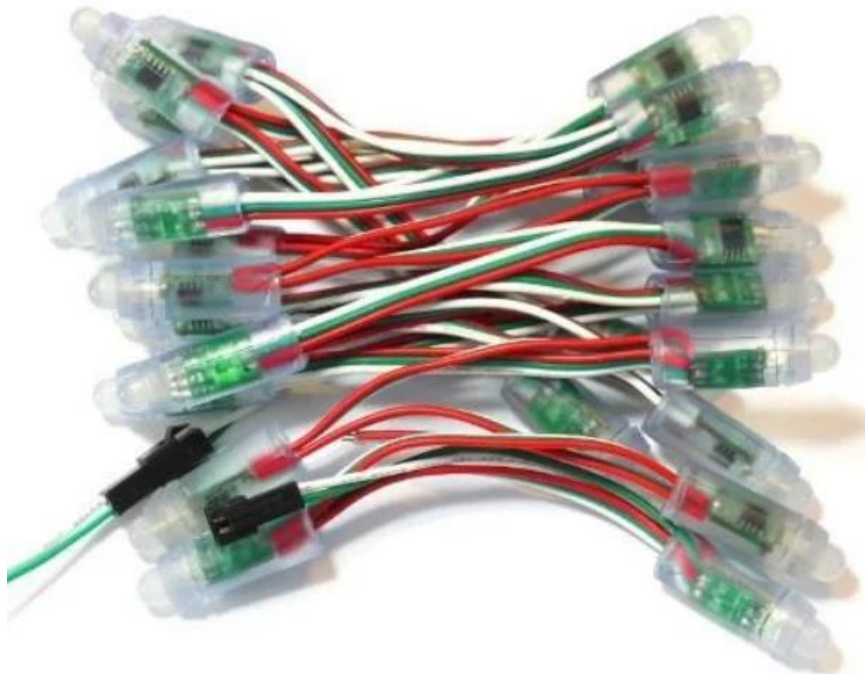
Рисунок 2.6 – Приклад RGB-стрічки WS2811 з потужними світлодіодами
