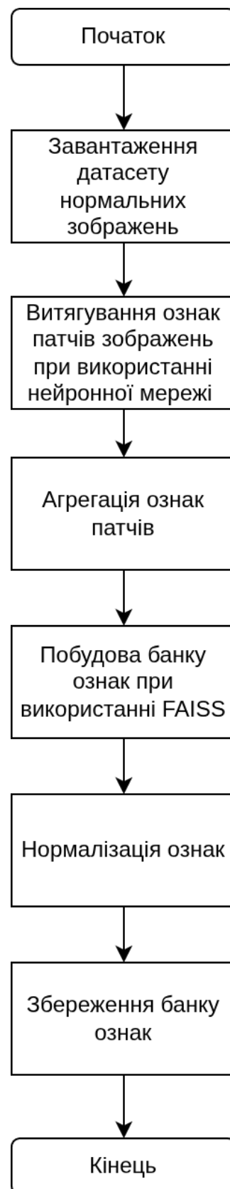
Рисунок Б.1 – Схема програми етапу тренування методу виявлення для системи виявлення дефектів
