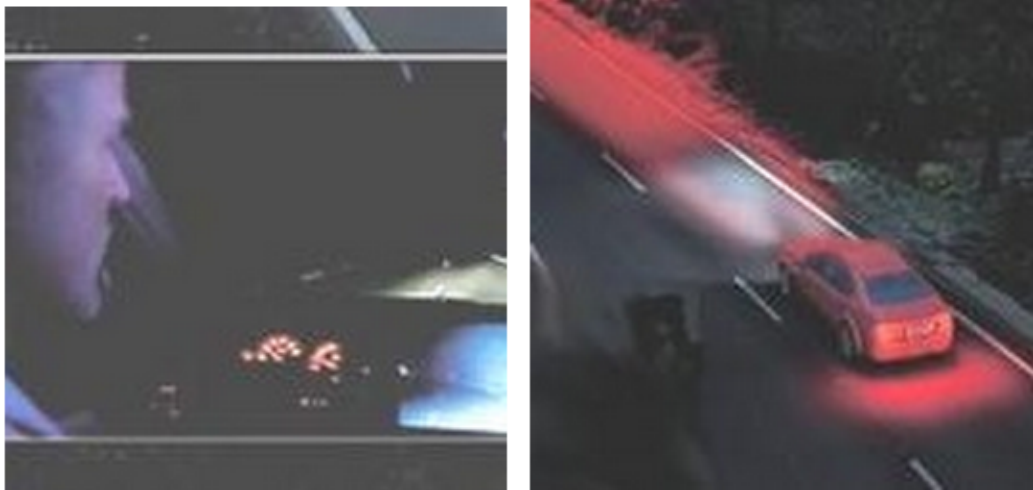
Рисунок 1.4 – Активна інфрачервона система нічного бачення
