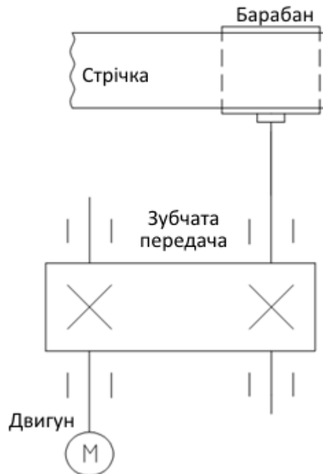
Рисунок 1.2 – Кінематична схема приводу конвеєра
