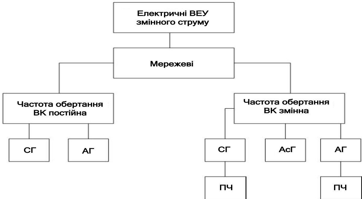
Рисунок 1.5 – Структурна схема мережевих ВЕУ: СГ – синхронний генератор; АГ – асинхронний генератор; АсГ – асинхронізований генератор; ПЧ – перетворювач частоти
