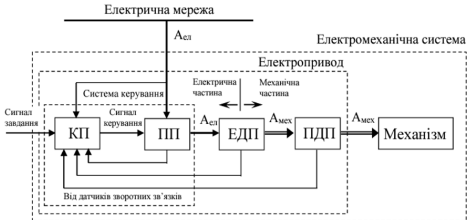
Рисунок 9 – Структурна схема системи керування ЕП центрифуги
