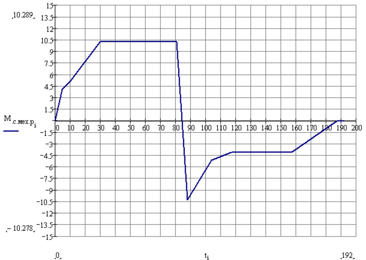
Рисунок 2.3 – Діаграма моменту статичного опору ротора центрифуги
