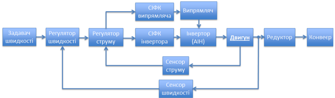
Рисунок 4.2 – Структурна схема системи керування електроприводом стрічкового транспортера
