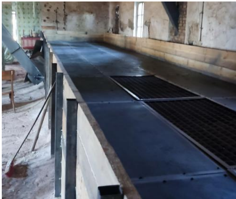
Рисунок 1.5 – Зовнішній вигляд сушильного столу виготовленого власними силами в умовах фермерського господарства
