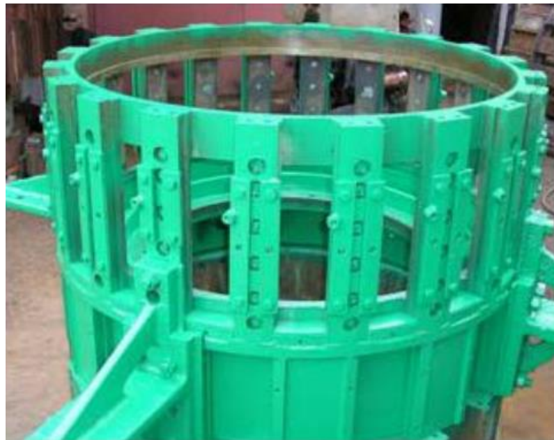
Рисунок 2.2 – Зовнішній вигляд барабана (16 рам) після модернізації
