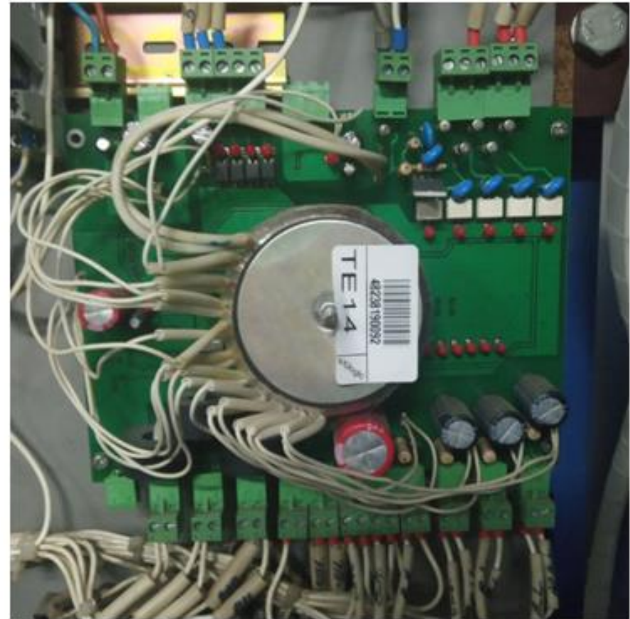
Таблиця 5.2 – Паспортні дані тиристорного перетворювача ТП4-320/460УХЛ4
