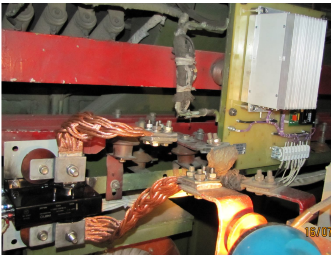
Рисунок 4.8 – Сенсор струму та панель спраження МСКЕ на електровозі
