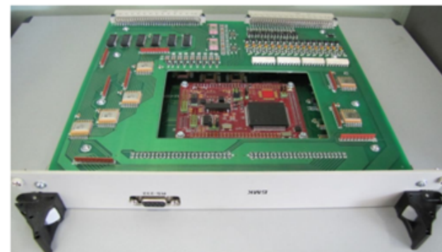
Рисунок 4.11 – Зовнішній вигляд мікропроцесорного блоку МСКЕ. Електронна плата змінного модуля блока МСКЕ
