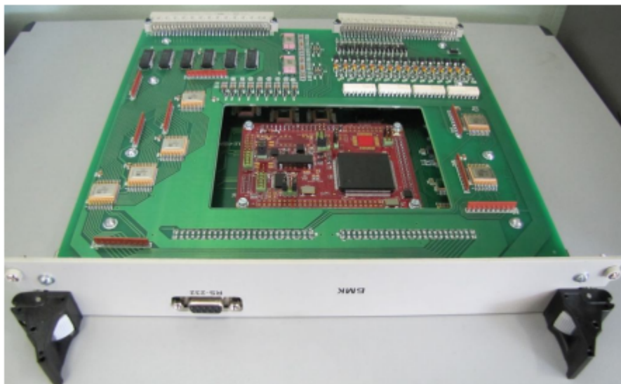
Рисунок 4.11 – Електронна плата змінного модуля блока МСКЕ
