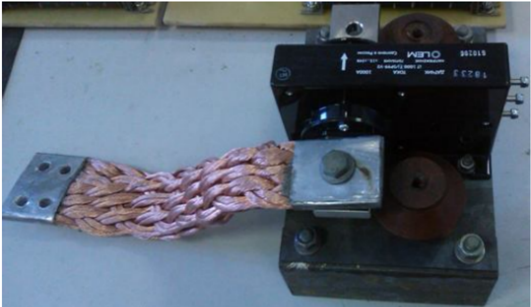
Рисунок 4.7 – Зовнішній вигляд сенсорів струму серії LTC
