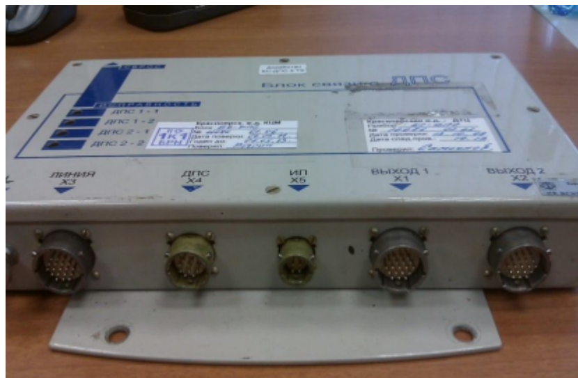
Рисунок 4.9 – Загальний вигляд блоку спряження для сенсорів швидкості
