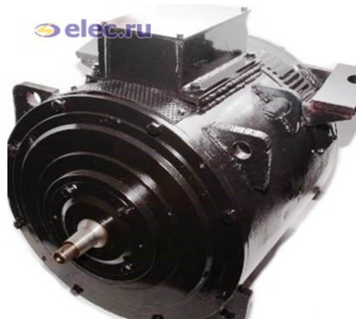
Рисунок 4.1 – Тяговий двигун для контактного електровоза типу ДТРН-23,5АС
