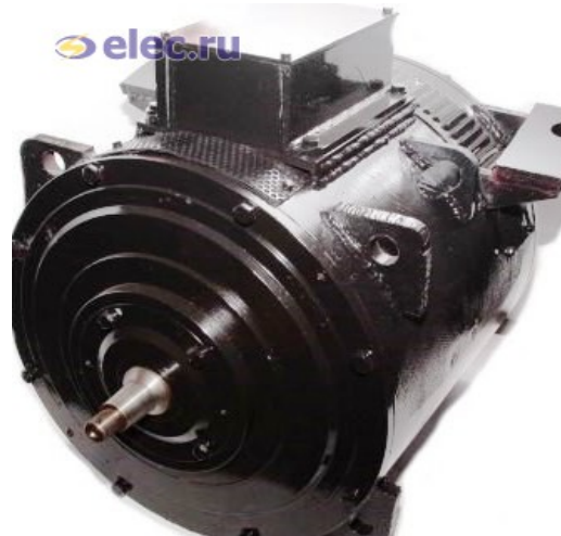
Рисунок 4.1 – Тяговий двигун для контактного електровоза типу ДТРН-23,5АС
