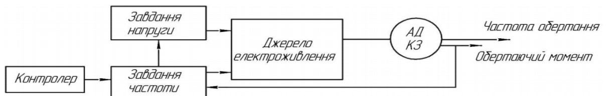
Рисунок 5.1 – Спрощена структурна схема асинхронного приводу шахтного електровозу
