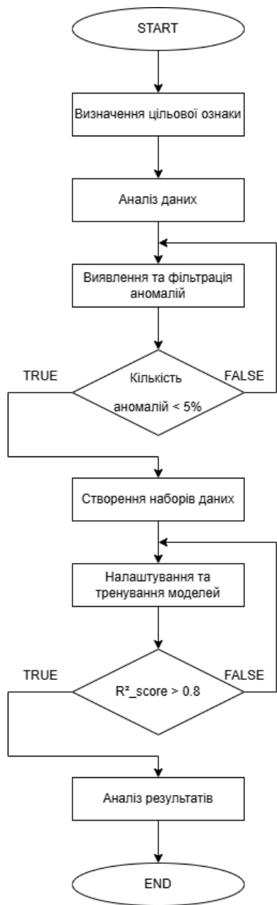
Рисунок Г.8 – Блок-схема алгоритму інформаційної технології аналізу водогосподарських балансів ділянок басейну Південного Бугу
