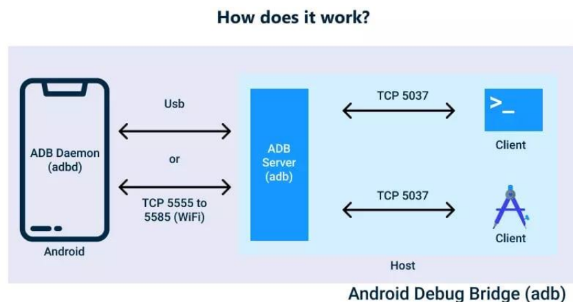
Рисунок 2.5 — Схема взаємодії компонентів Android Debug Bridge (ADB)
