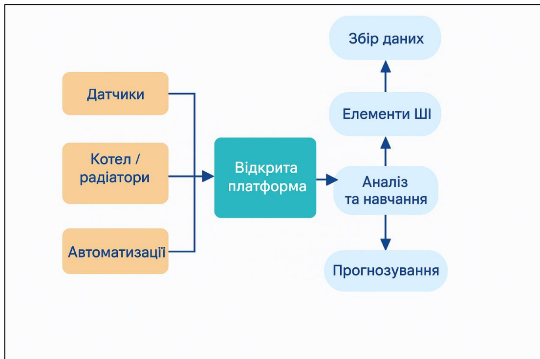
Рисунок 1.4 – Схема взаємодії відкритої платформи з компонентами системи та елементами ШІ
