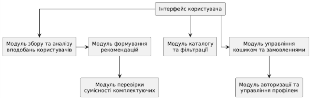
Рисунок Г.1 - Структурна схема функціонування веб-застосунку.
