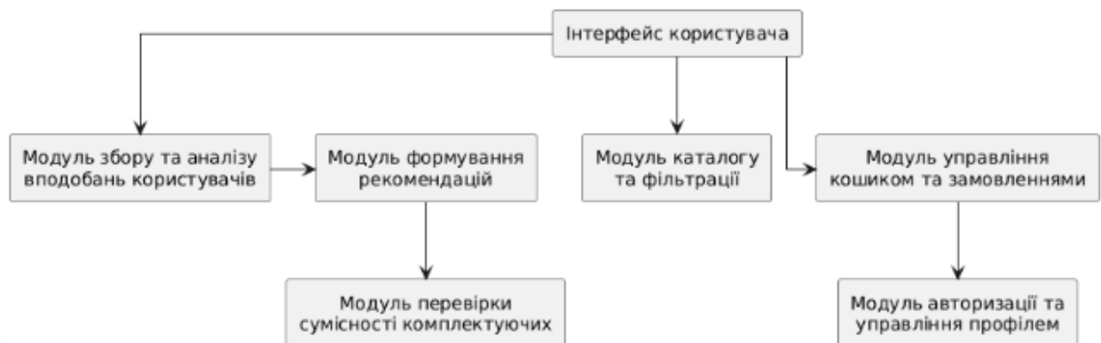
Рисунок 3.2 – Структурна схема функціонування веб-застосунку
