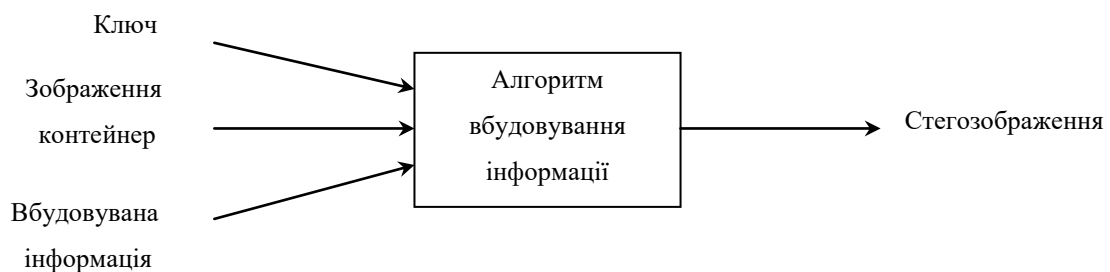
Рисунок 1.4 – Загальна схема вбудовування інформації в зображення
