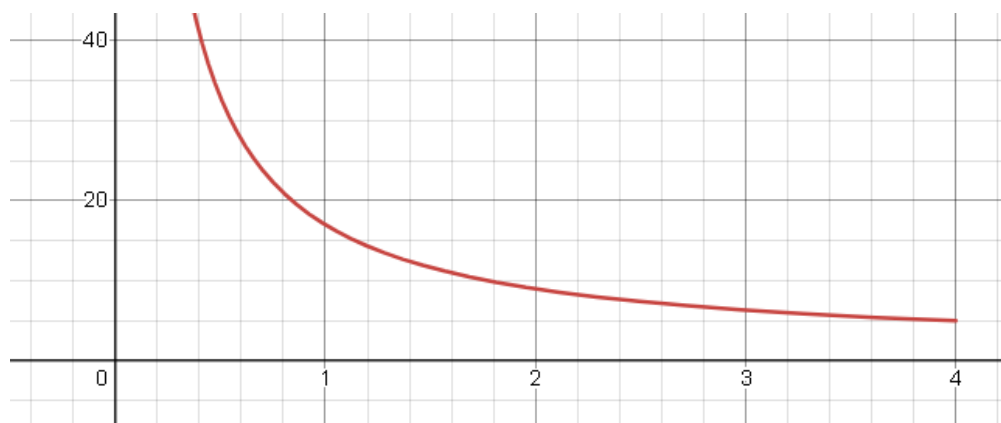
Рисунок 2.5 – Залежність складності алгоритму від кількості біт, що приховуються в одному пікселі
