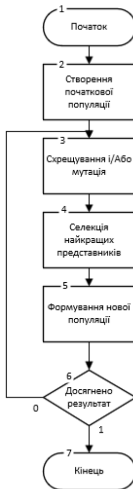
Рисунок 3.2 – блок-схема роботи генетичного алгоритму
