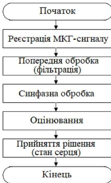
Рисунок 2.6 - Алгоритм обробки МКГ-сигналу
