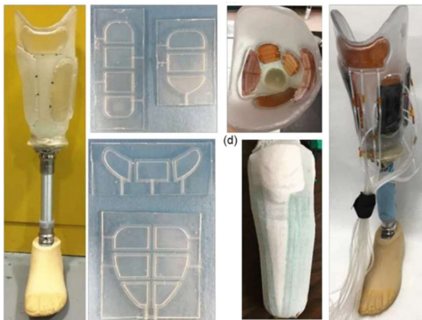
Рисунок 3.4 – Конструкції регульованих гільз за принципом надувного мішка
