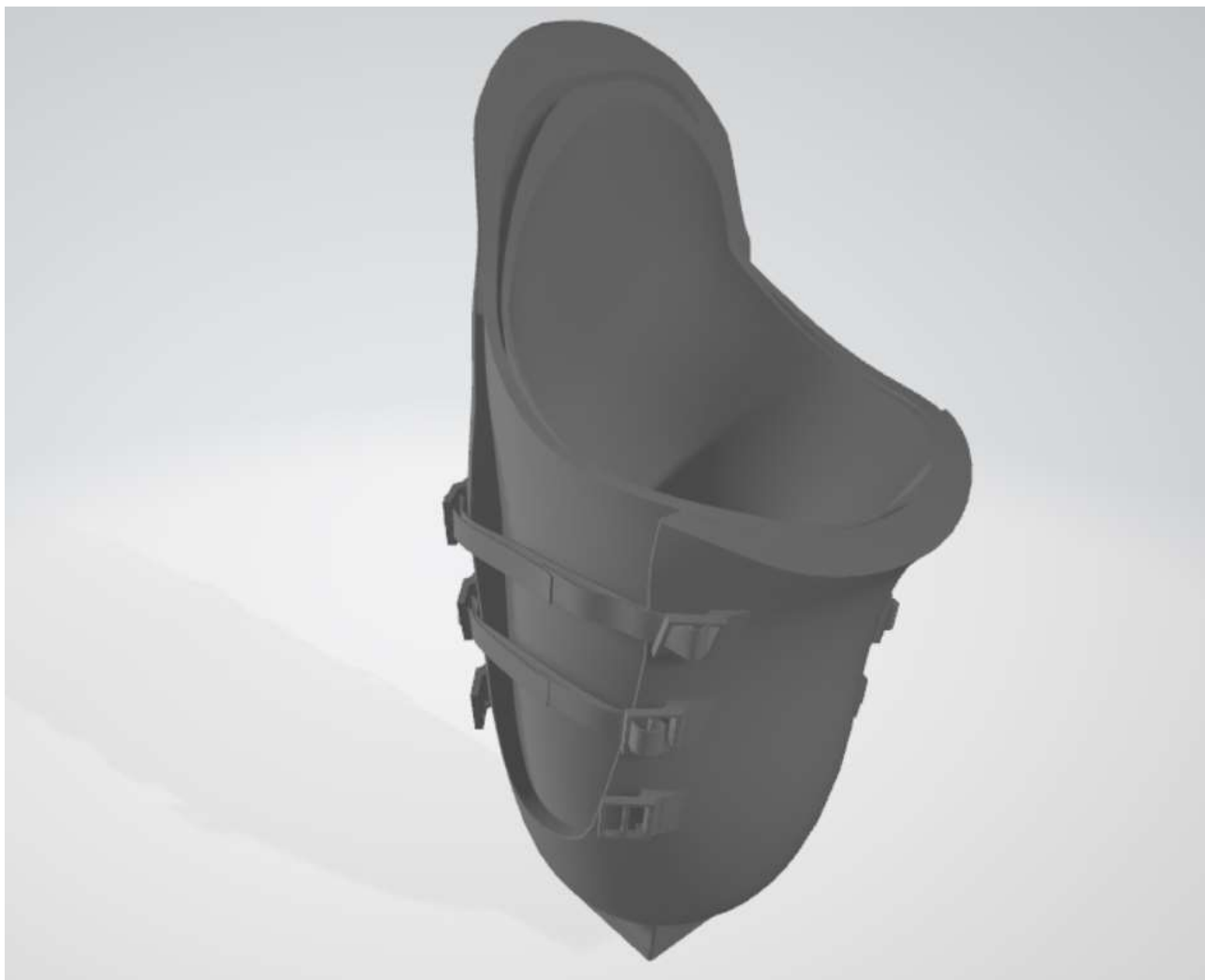
Рисунок А.4 – 3D-модель куксоприймальної гільзи з регулюванням об'єму
