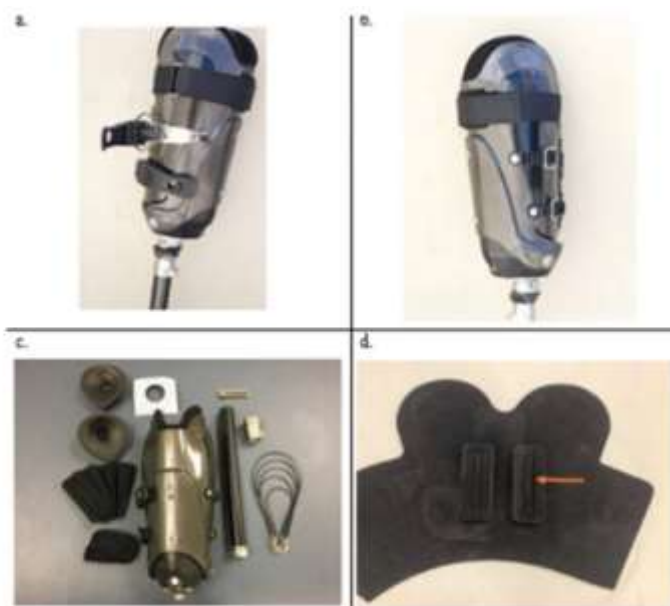
Рисунок 3.3 – Регулювання об'єму гільзи за допомогою широких зовнішніх стяжок
