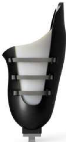
Рисунок 3.5 – Ескіз пропонованої конструкції куксоприймальної гільзи
