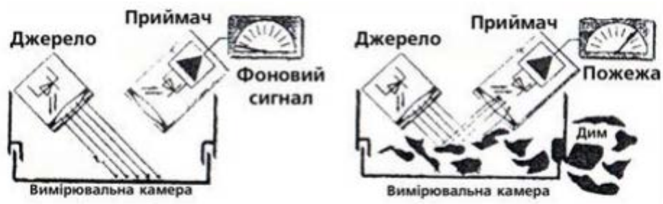
Рисунок 3.3 – Умовне зображення димової камери в нормальному стані і в тривозі
