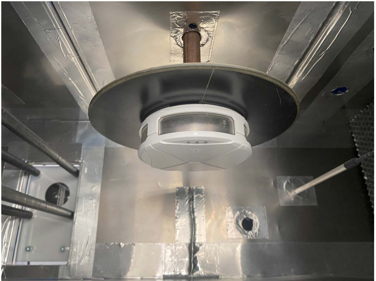
Рисунок 3.10 – Встановлення сповіщувача всередині димового тунелю
