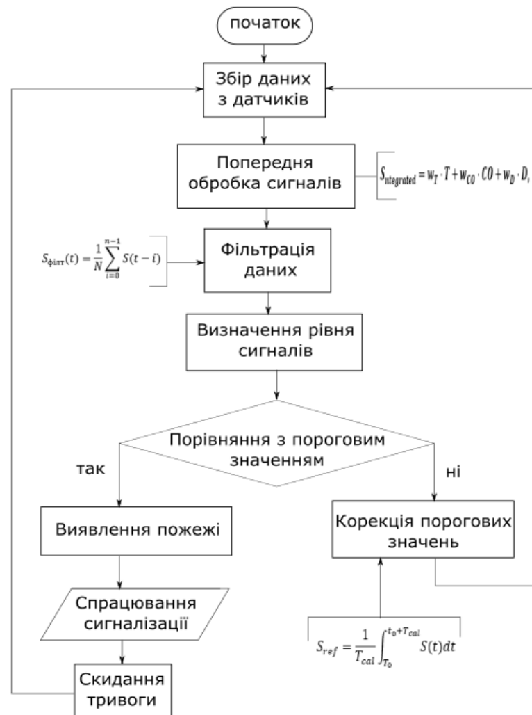
Рисунок 2.9– Алгоритм роботи димогово сповіщувача
