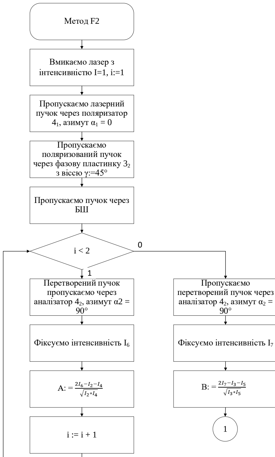
Рисунок В.3 – Блок-схема методу вимірювання розподілів фазових кутів елементів матриці Джонса в системі
