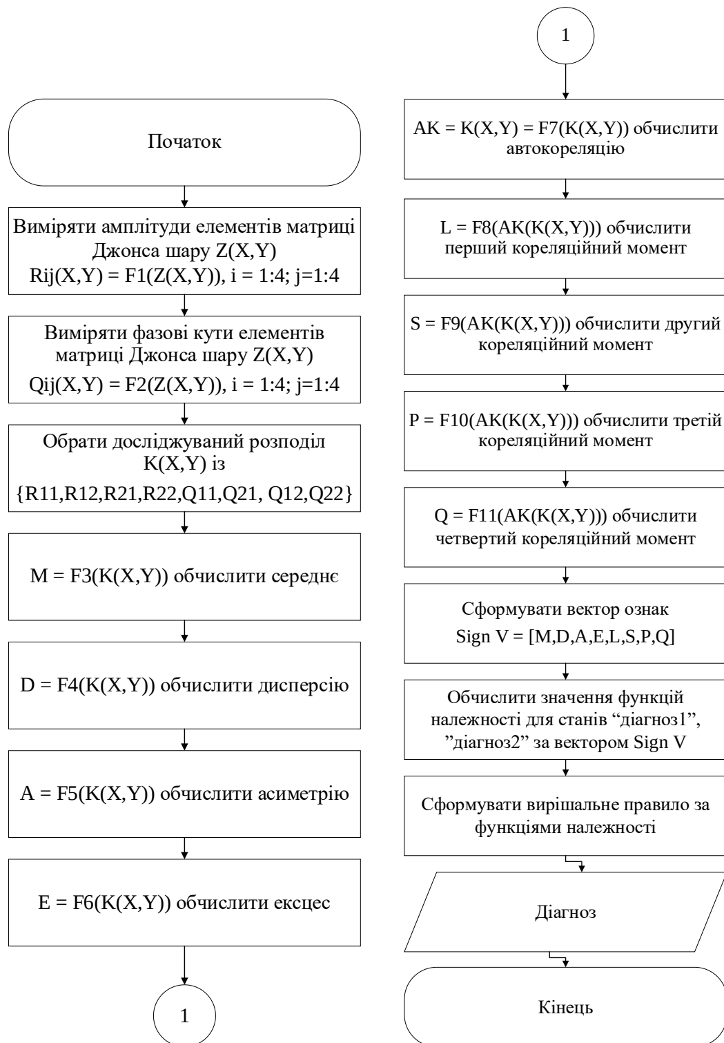
Рисунок 2.11 – Блок-схема алгоритму діагностики біологічних шарів за їх Джонс-матричним картографуванням
