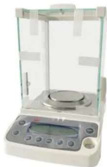
Рисунок 3.4 – Прецизійні електронні ваги: a – ADAM Highland HCB 123; б - BSM-1.204 1/10000 [24]
